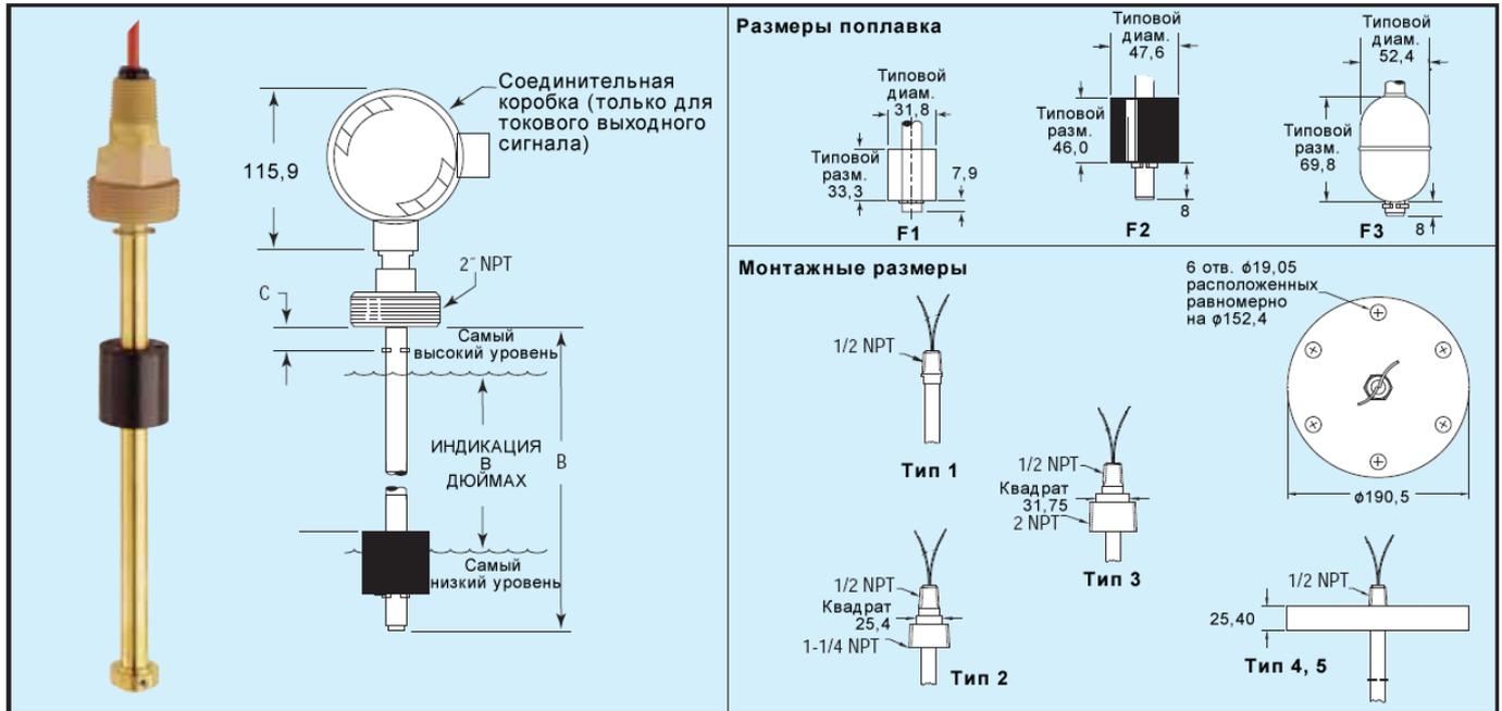
**Датчики с непрерывным выходным сигналом об уровне** обеспечивают поминутный мониторинг уровня в резервуаре. Датчики уровня изготавливаются в соответствии с техническими требованиями для непосредственного использования у заказчика. Датчики могут конфигурироваться для получения выходного сигнала 4-20 мА или пропорционального выходного сигнала напряжения, поплавков из нержавеющей стали или Buna-N и длин до 183 см.
