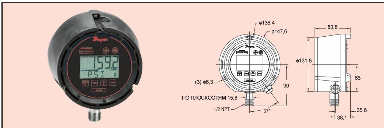
Цифровой показывающий датчик серии DSGT представляет собой универсальный многофункциональный манометр для технологического процесса, который имеет превосходную точность  $0,25\%$  от полной шкалы. Манометр серии DSGT имеет датчик с выходным сигналом от 4 до 20 мА питаемый от измерительного контура.
